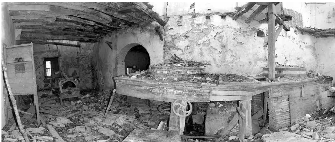
De izquierda a derecha: cernedor, limpia belga, bancada con dos parejas de piedras encima y la turbina con engranaje, debajo.
