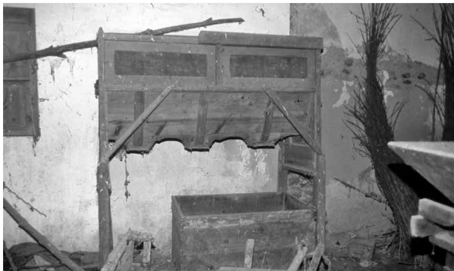
Cernedor con conductos para tres fracciones de harina
