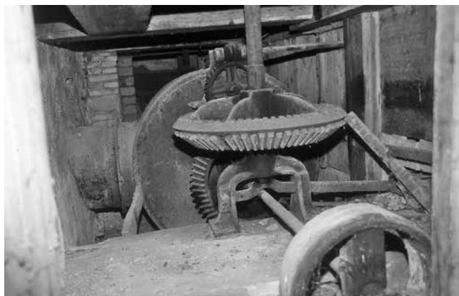
Turbina con regulador y embrague; piñón con dientes de madera
