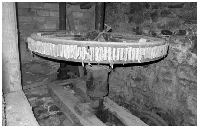
Engranaje con dientes de madera Broto — 2017
