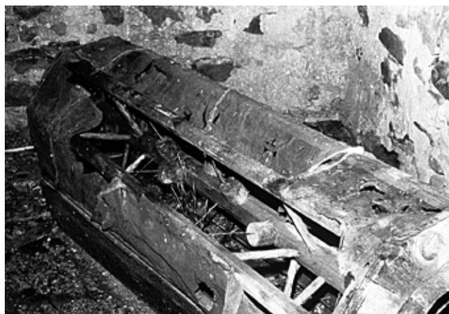
Esqueleto prismático de madera del cernedor: Fíjate en la tela y las mazas
