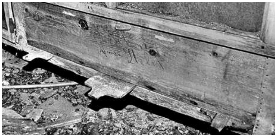
El cernedor muestra los números 1, 2, 3 que indican las salidas de las tres calidades de harina
