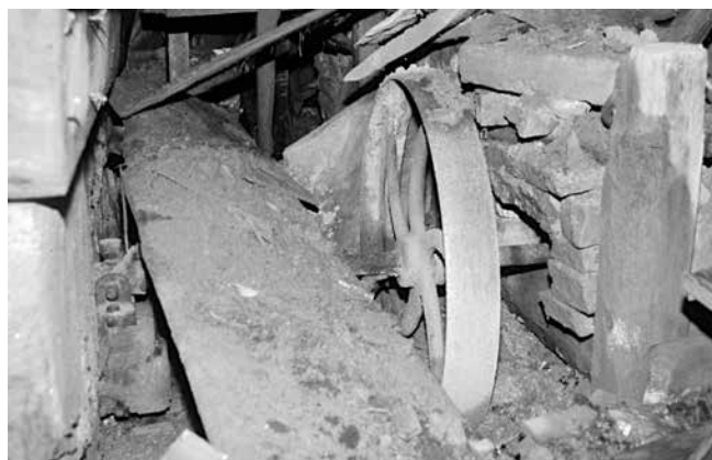
Rueda de cinta para impulsar otros equipos — 2002
