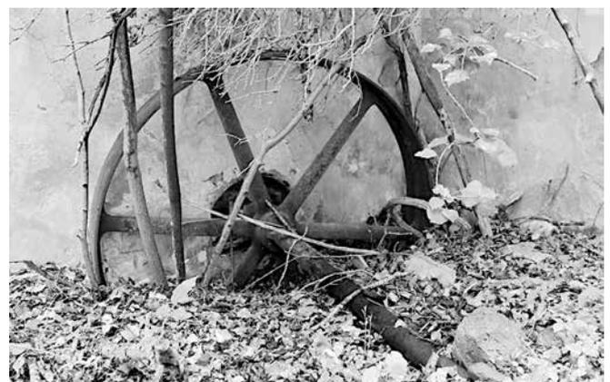
Rueda de cinta en un eje, que se conecta a la turbina
