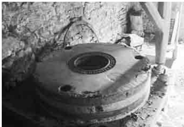
Una volandera. Una muela de La Ferté. Fíjate en el sello y los tres huecos para equilibrar la muela. Se ve también el hueco para sujetar la grúa. (Paternoy, 2011)
